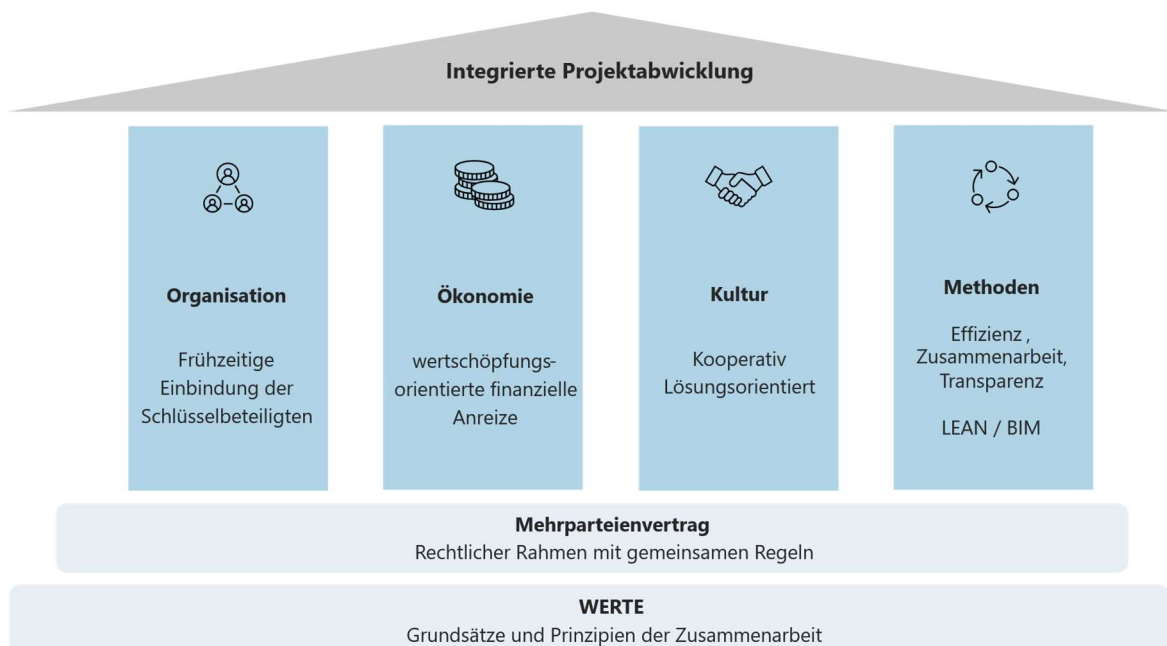
Abbildung 4: Das IPA-Haus: Die Bausteine der Integrierten Projektabwicklung
