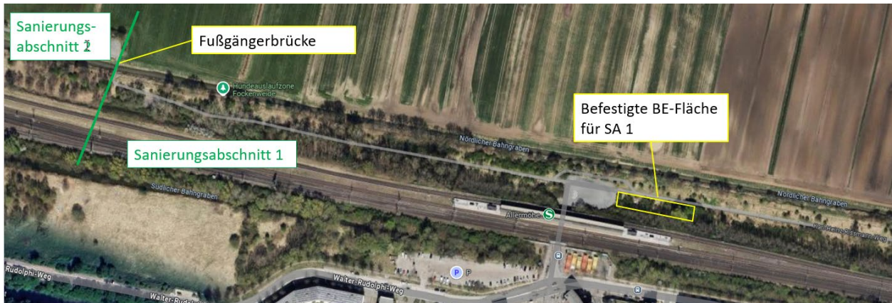
Abbildung 4: Baustelleneinrichtungsfläche im Sanierungsabschnitt 1 bei der S-Bahn-Station Allermöhe.
